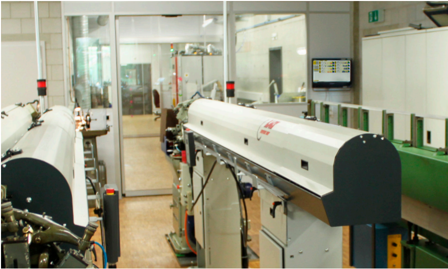
In der Werkstatt erkennt man einen ScreeN-Bildschirm für die Decolleteure. Jeder sieht nun auf einen Blick auf einer Produktionsübersicht, welche Maschine läuft, was sie produziert, welche gestoppt wurde und seit wann.
