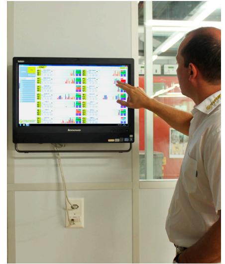
In der Werkstatt erkennt man einen ScreeN-Bildschirm für die Decolleteure. Jeder sieht nun auf einen Blick auf einer Produktionsübersicht, welche Maschine läuft, was sie produziert, welche gestoppt wurde und seit wann.
